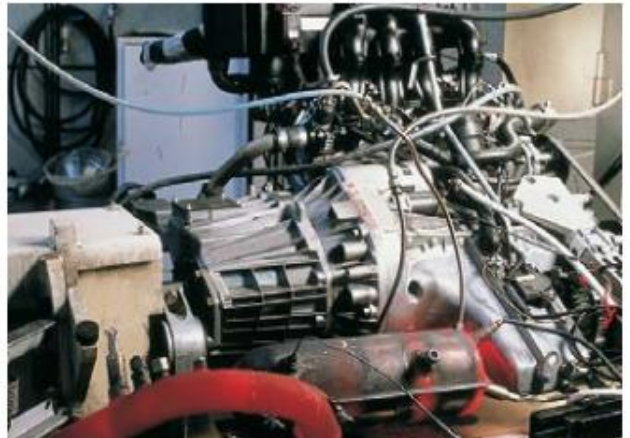
Medición dentro de un motor de combustión bajo duras condiciones de test
