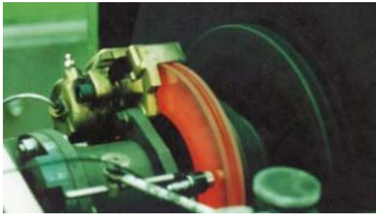
Medición del desgaste en un disco de freno
