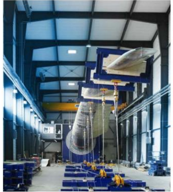
Durante las pruebas de carga, varios sensores de hilo miden la deformación de las palas del rotor para turbinas de viento.
