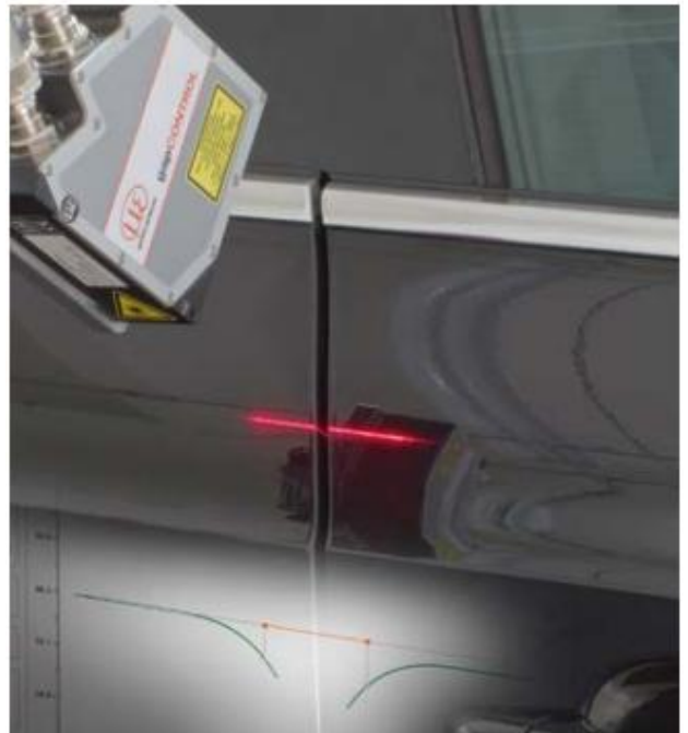
Medición de espacios en piezas de carrocería
