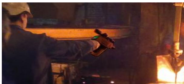
Medición sin contacto de temperatura a distancia segura
