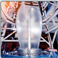
Desde el momento en que la fundición sale a través de la matriz en el extrusor, debe medirse la temperatura de la película tubular en varios puntos para garantizar la calidad del producto.
