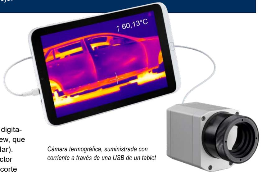
Cámara termográfica, suministrada con corriente a través de una USB de un tablet
