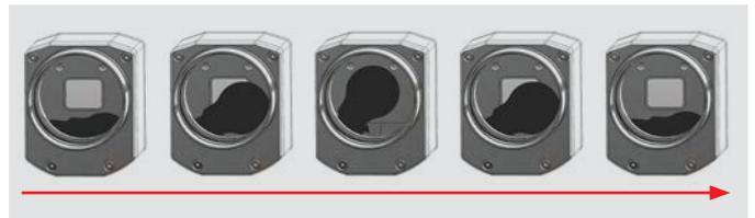
*Para referenciar la desviación se cierra brevemente el campo visual del conjunto del sensor de infrarrojo*
