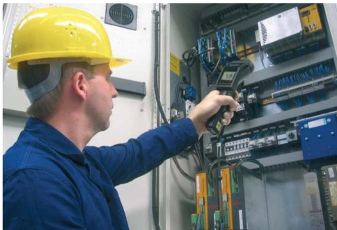
Medición detallada de la temperatura por infrarrojo en un control eléctrico con ayuda de la lente de punto focal integrada del optris® LS LT en el rango de 1 milímetro.
