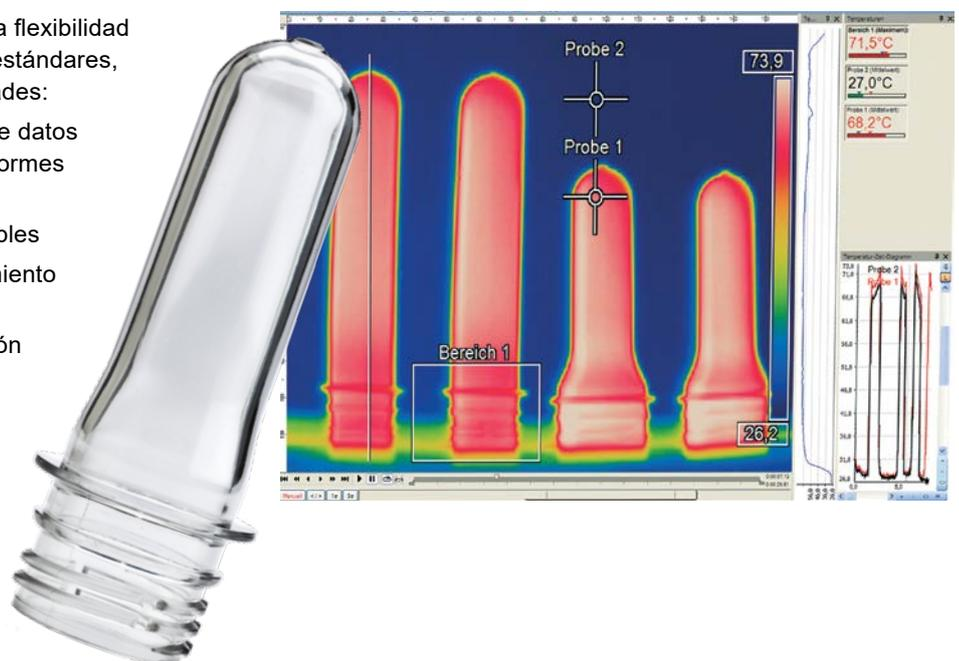
movimiento del material en un ángulo oblicuo – similar al último vagón de un tren en marcha –. El resultado es el perfil de temperatura de una secuencia vídeo IR, que es esencial para ajustar los parámetros de calentamiento.
