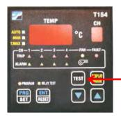
Apretando la tecla TEST durante 5 segundos permite efectuar un test de los relés.
