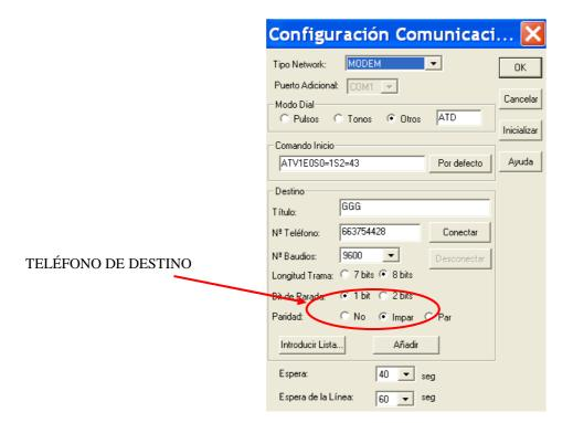
Una vez realizada la conexión de los MODEM, el procedimiento de trabajo es el normal. Para entrar online con el autómata se tendrá que seleccionar , y volver a seleccionarlo para salir del modo ONLINE.
