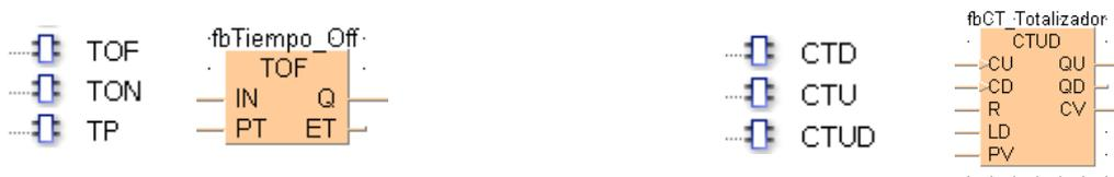
Muchos de estos bloques de funciones del tipo temporizador trabajan con variables del tipo TIME (ej.: T#5s) que incorporan no solo el valor a temporizar sino su base de tiempos. La estructura de este tipo de variables es:
