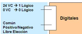
Las entradas en los PLCs de Panasonic requieren de una tensión de entrada (generalmente 24VCC) para activarse, pudiéndose cablear el común al positivo o al negativo de la misma.
