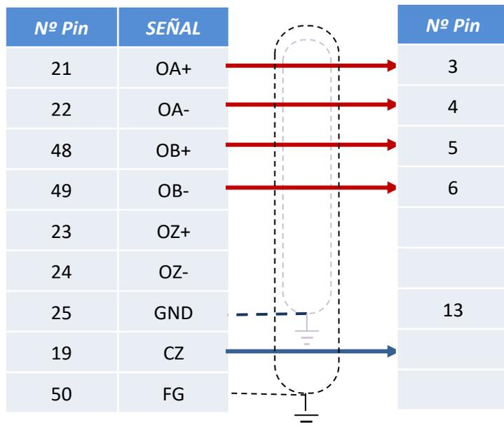
Salida a colector abierto NPN
