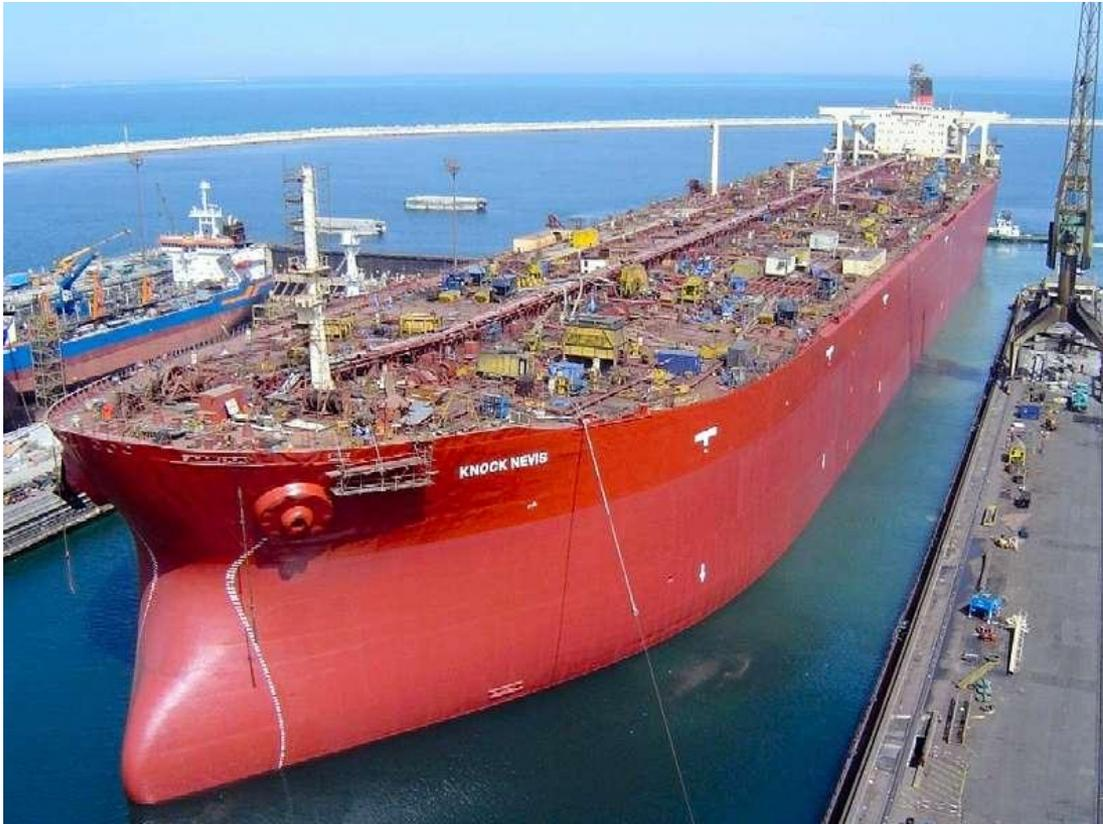
458 metros de largo, 69 de alto - a plena carga de 647.955 toneladas de petróleo, la velocidad máxima de 30 km / h .... Para detenerse necesita cerca de 2,5 millas (4,6 kilómetros)
