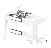
Para el desmontaje usar un destornillador y forzar ligeramente los ganchos de fijación para hacerles salir de la guia de bloqueo.
