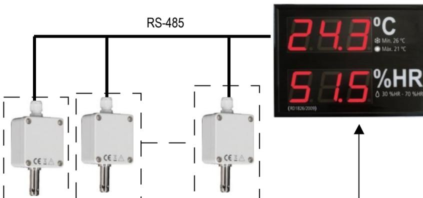
Indicación de la Media de temperatura y Humedad de diferentes zonas 2, 4, 6... etc para locales de 2000, 3000 ...5000 m2
