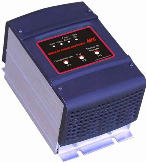
El módulo MFC permite el frenado rápido, suave y sin fricciones de motores trifásicos mediante la inyección controlada (por microprocesador) de corriente continua cuando se abre el contactor principal.
