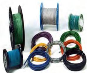
Los cables de compensación se utilizan para desplazar la unión de referencia del termopar hasta una zona de temperatura moderada y constante. Están compuestos de un material que, en la escala de 200°C, tienen la misma termotensión que el termopar en cuestión y, están disponibles con conductores rígidos o flexibles, con diferentes tipos de aislamiento. Para termopar tipo: J, K, L, T, E, S, B, R, N
