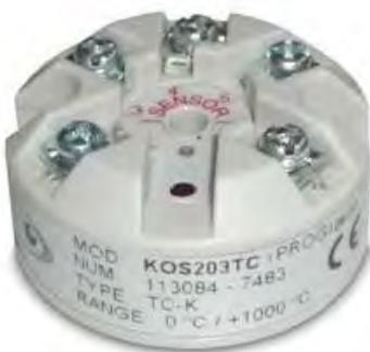
En su lugar, el 203TC usa un pulsador para seleccionar el tipo de termopar y el rango del transmisor. El 203TC incorpora la última tecnología digital asegurando una linealización libre de derivas no disponible con los sistemas analógicos. Con aislamiento galvánico.
