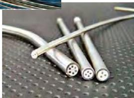
Los termopares encamisados, son utilizados para altas temperaturas. Termoelementos encamisados, camisa de metal, de 2 a 8 conductores interiores. El aislamiento es polvo de óxido de magnesio.
