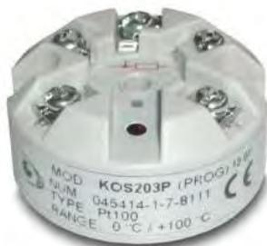
El transmisor de cabezal DIN 203P incorpora la última tecnología digital para asegurar una precisión libre de derivas. Se conecta a cualquier sonda de temperatura Pt100 y convierte la salida a una señal lineal 4-20mA dando unas prestaciones para la industria en general realmente buenas, como se puede comprobar mas abajo.
