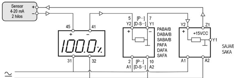
Visualización, alimentación del sensor y varios puntos de consigna, utilizando varios modelos.
