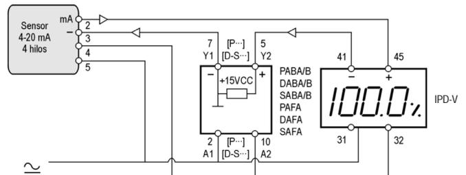
Visualización, alimentación del sensor (4 hilos) y 1 ó 2 puntos de consigna.
