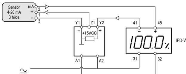
Visualización, alimentación del sensor (3 hilos) y 1 ó 2 puntos de consigna.
