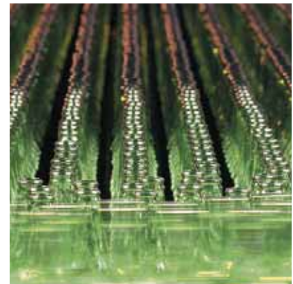
Campo de aplicación característico de los detectores de contrastes: recuento de botellas de cristal.
