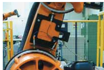
Limitación del área del eje del robot, supervisado por el detector GG505S.
