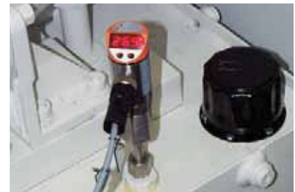
Indicación in situ de los valores actuales de temperatura.
