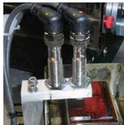
Carcasa de color negro transparente para una óptima visibilidad de los LEDs.
