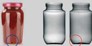
El sistema de inspección por rayos X de doble haz evita ángulos muertos al inspeccionar tarros de vidrio.
