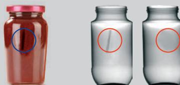
Detección fiable de una fina astilla de cristal, probablemente no detectada con un sistema de un único haz.
