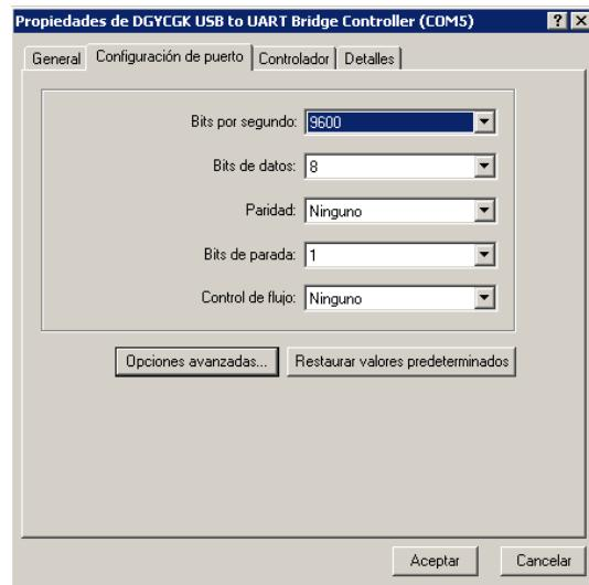
5. Abrir el software de programación del autómata S7-200 (Siemens o Cotrust PLC), hacer click en herramientas > set PG/PC interface y hacer click en propiedades
